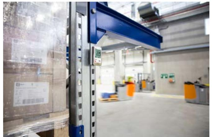
Positionnement d'un enregistreur de données à proximité d'une zone de chargement et de déchargement (point critique)
