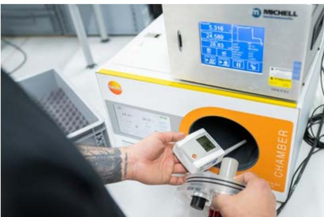
Etalonnage d'un enregistreur de données de température et d'humidité dans un humificateur
